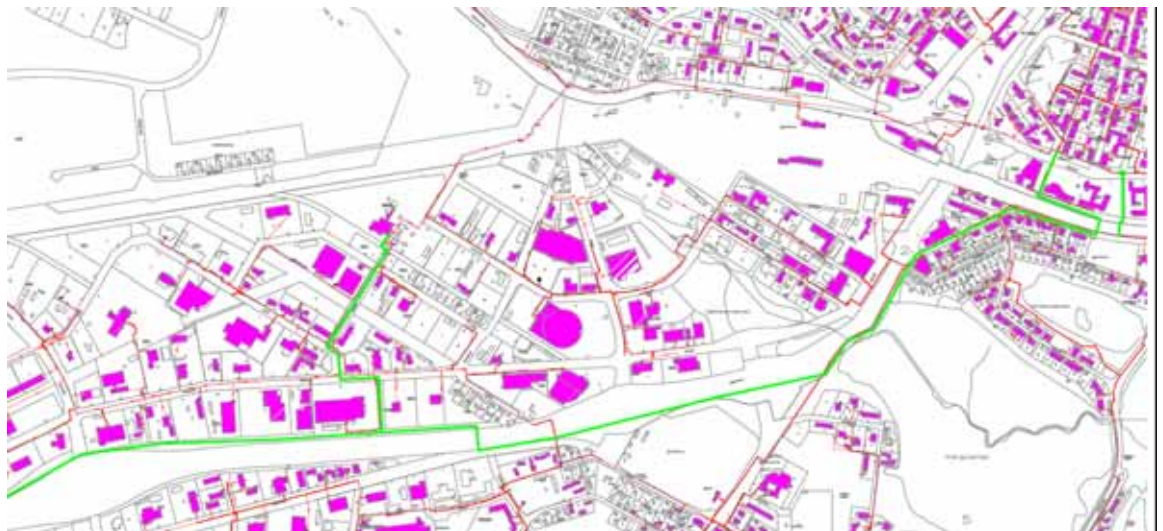
Kuva 7.33. Kaukolämpöputkien reitti Mustikkamaan bioenergiailaitokselta keskustaan, alustava.
